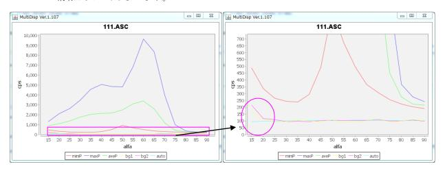
極点図の外側でバックグランドが上がる傾向が有ります。
