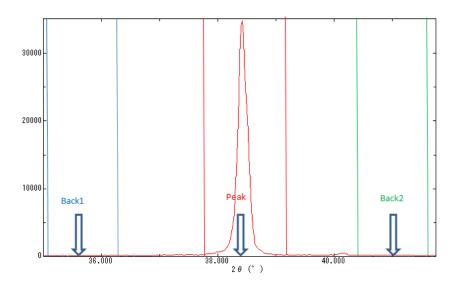
各種補正のerrorを考えると、反射法より、 $\mu$ t=1近くにした透過法が有利です。 しかし、材料によっては、透過法で測定出来ない事が多く、一般的には反射法が用いられています。 反射法の場合 defocus補正が必須で補正量を考えると、測定2 $\theta$ 角度を高角度、受光スリットは広くして測定すると補正量が小さくなります。測定2 $\theta$ を高角度にするには、波長を大きくすれば可能です。
