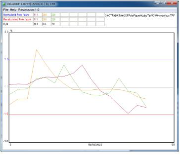
極点図の外側(図の右側)が下がる傾向があり、 d e f o c u s 補正が不十分である事が分かります。
