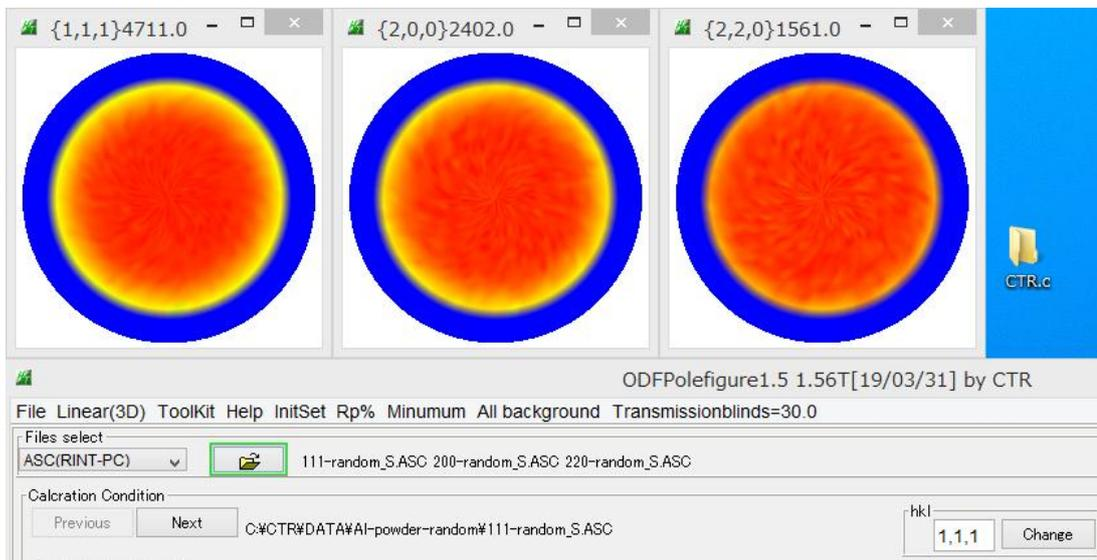
C a l c でバクグラウンドが削除され、極点図が表示される
