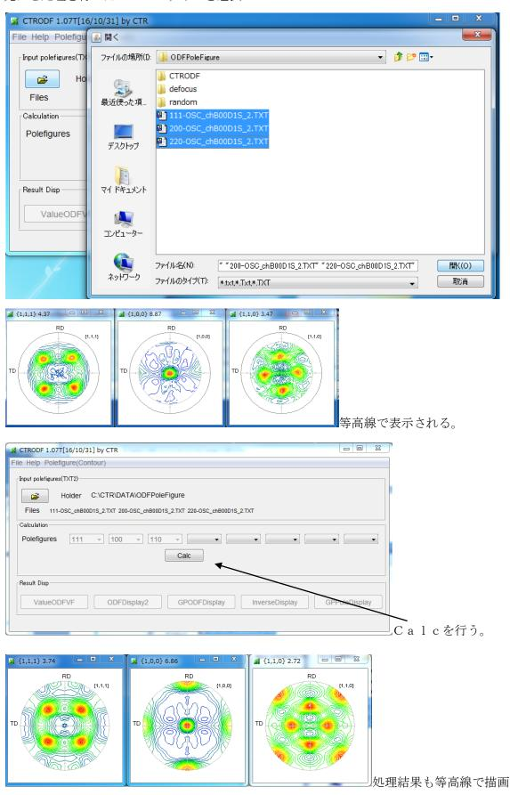
ODF 解析後の再計算極点図が表示されます。
