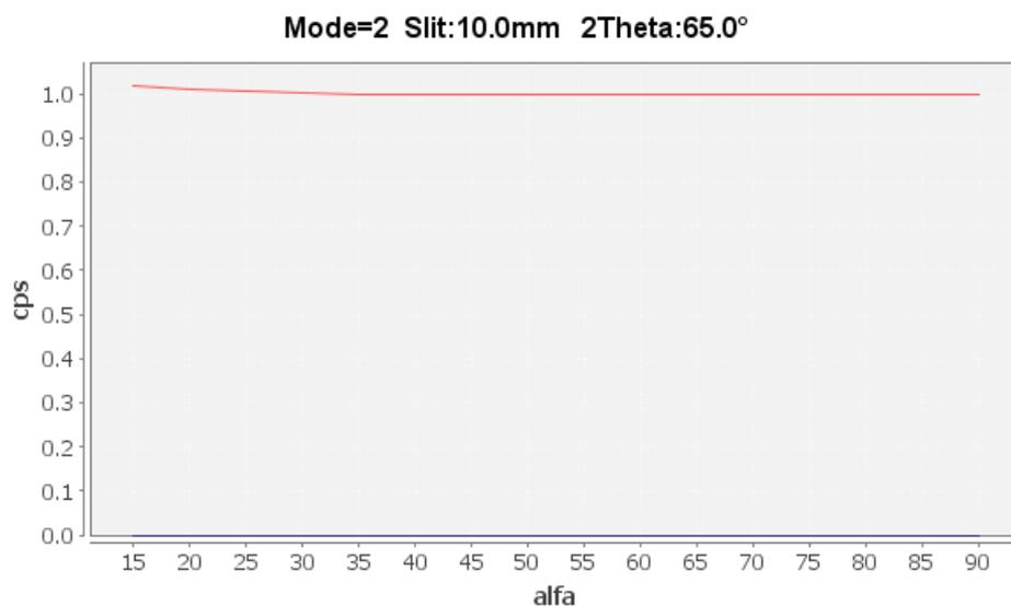
極点図の中心が高く測定される補正が行われます。
