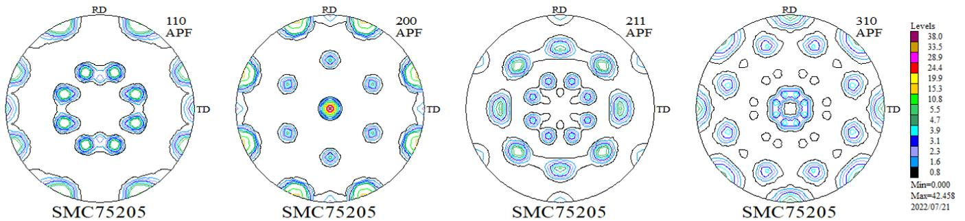
極点図の測定では測定間隔5度が一般的である。間隔を狭くすれば、正しい強度測定が可能になるが測定時間が長くなり、ODF図表示もスピードが遅くなります。
