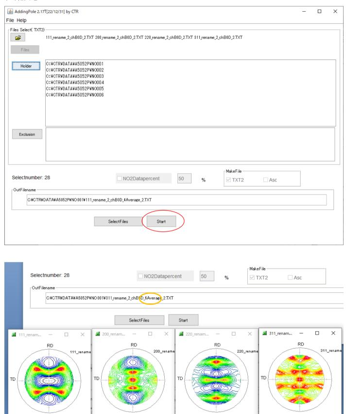
6個の極点図平均が計算され、平均化された極点図は最初にTXT2を選択したホルダに作成
