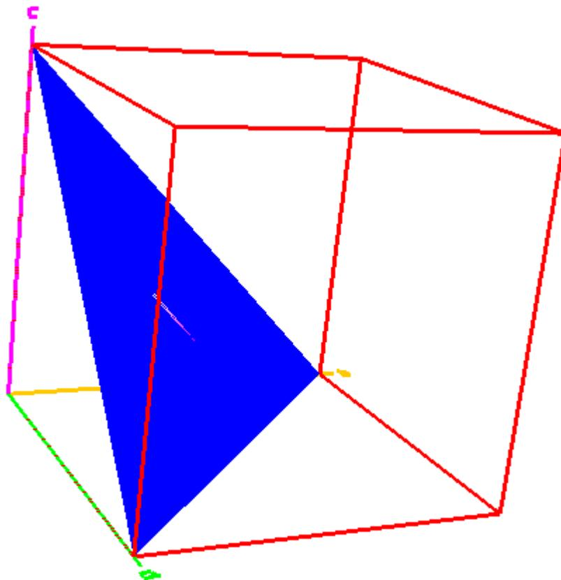
a 軸は緑、b 軸はオレンジ、c 軸は紫で表し、材料面は、青色、ピンクは裏側、RD 方向は矢印
