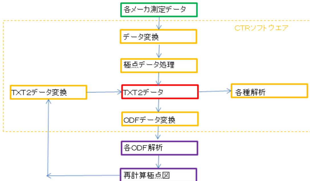
各メーカーの X 線測定装置で測定されたデータをデータ変換し極点データ処理を行うと T X T 2 データが作成され、各種データ解析が行われています。
