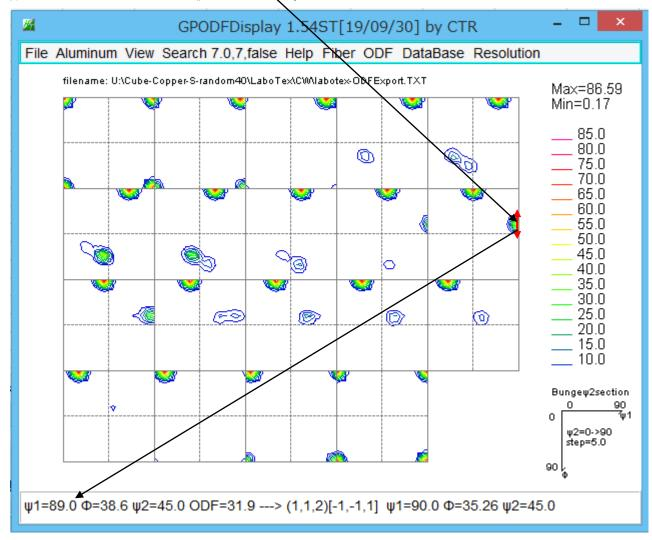
常にcopper位置を表示させるのは、CrystalOrientationでeuler角度を決定して表示
